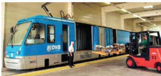
Une option de transport pour la digue Bickerdike et le Technoparc. Tel que le démontre le Cargo Tram de VW, les systèmes sur rails légers peuvent transporter plus que de simples passagers.
